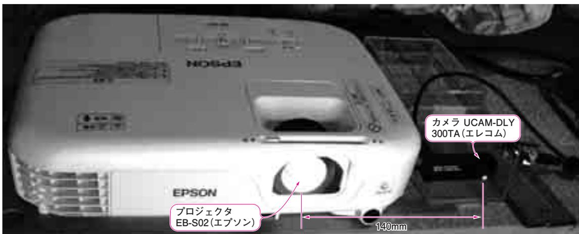
写真1 手持ちのUSBカメラとプロジェクタで作ったオリジナル・モーション・キャプチャ・センサ
