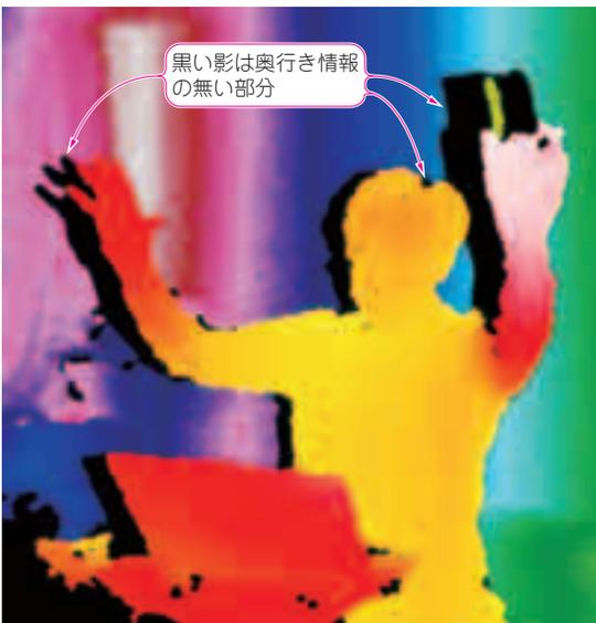
図1 Kinectが装備するカメラが見ている画像
