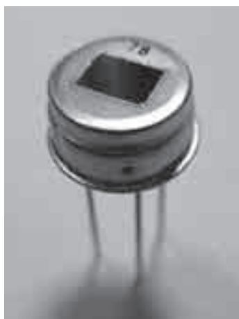
写真1 防犯ライトなどによく使われている定番「焦電型赤外線センサ」 誤動作や検出漏れが多い
