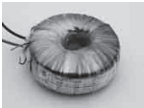
写真1 100 V:12 V 50VAトロイダル・トランス RSコンポーネンツ製の115 V品を改造したもの
