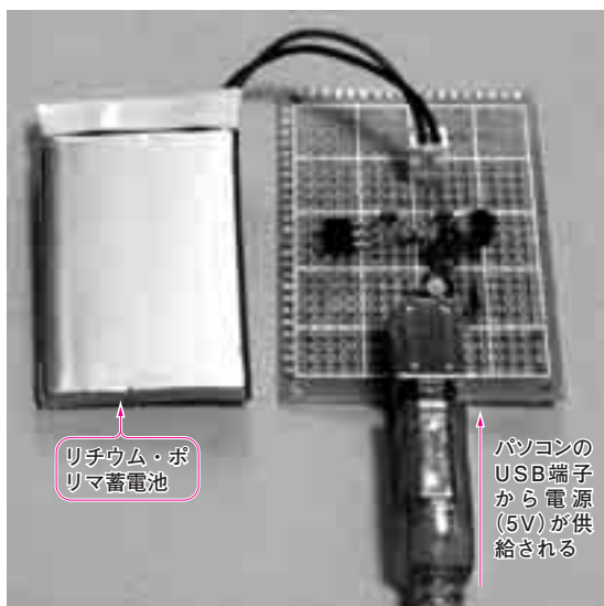
写真1 リチウム・ポリマ蓄電池用充電回路
