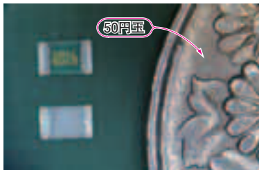
写真1 2125サイズ(2×1.25mm)のチップ抵抗は米粒よりも小さい
