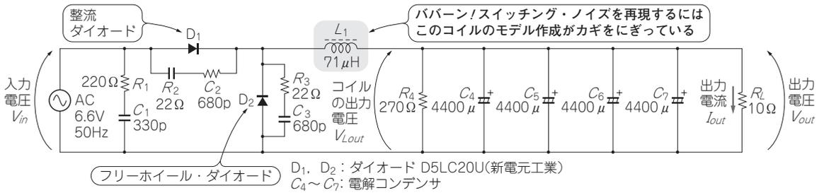
図1 今回再現するスイッチング電源回路(FCC回路)とモデルを作成するコイル
