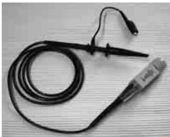
写真12-1 オシロスコープを買うと付いてくる「パッシブ・プローブ」で正しく測れる限界は？
