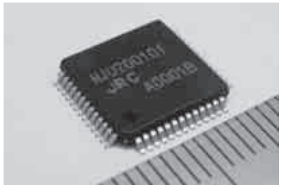
写真1 デジタル制御電源用コントローラNJU20010(新日本無線)
