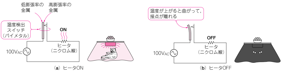
図1 寒い冬に欠かせないフィードバック・システム「こたつ」の温度制御のしくみ
