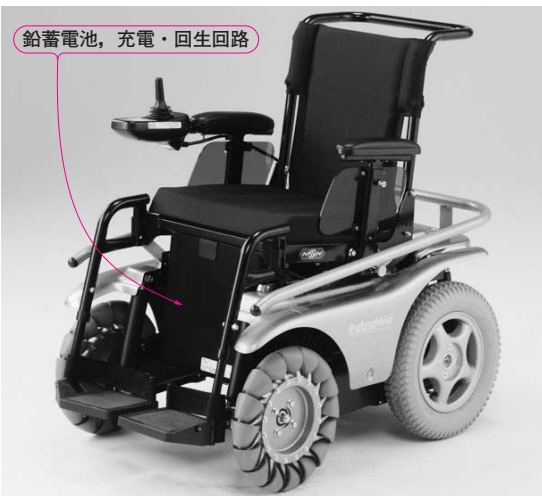
写真1 鉛蓄電池を動力源として搭載する電動車いす 左右の前輪には車輪の向きを変えずに車いすの進行方向を変えられるWESNホイールを使っている
