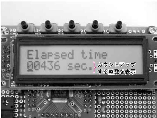
写真4-1 カウントアップ(1秒間隔)する整数をLCDに表示
