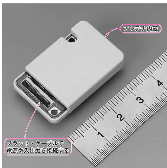
写真2 ZigBee 準拠の無線モジュールの例 ZB24FM-Z2501-01 (NEC エンジニアリング)、電源電圧 3.0 V、送信時消費電流 48 mA、受信時消費電流 51 mA、待機時消費電流 20 \mu A 以下
