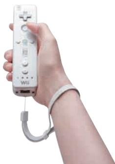
民生用途で最近話題になっているのが、任天堂のWiiに代表されるゲーム機です。初期のゲーム機のコマンド入力手段は押しボタンだけでしたが、最新機種は加速度センサを利用し、人間の動きをコマンドにかえて入力できるようになりました。ボタンに一切触れず、直感的にゲーム機を操作できます。
