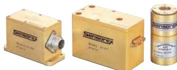
建物の地盤の傾きを測定する傾斜計も加速度センサの一種です。重力加速度の方向を検出し、鉛直方向からの傾きを求めます。よく利用されている泡を利用した水準器は水平の検出だけですが、加速度センサを利用した傾斜計は任意の傾きをデジタル値で読み取ることができます。携帯型のもので、1分(1度の1/60)以下の分解能で測定できるものもあります。
