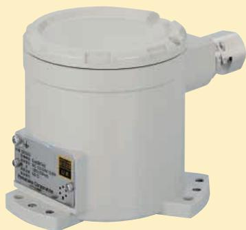
1995年に発生した阪神淡路大震災の頃から地震センサが活用されるようになりました。地震センサは震度の測定だけでなく、設備の安全を確保するための制御に利用されています。写真のインテリジェント地震センサSES60(山武アドバンスオートメーションカンパニー)は、地震を検知すると各地区に設置されている地区ガバナステーションと呼ばれるガス供給設備のバルブを閉じ、大きな地震が発生した地域だけガスの供給を停止します。集められた地震情報をリアルタイムで一般に提供するサービスも行われています。
