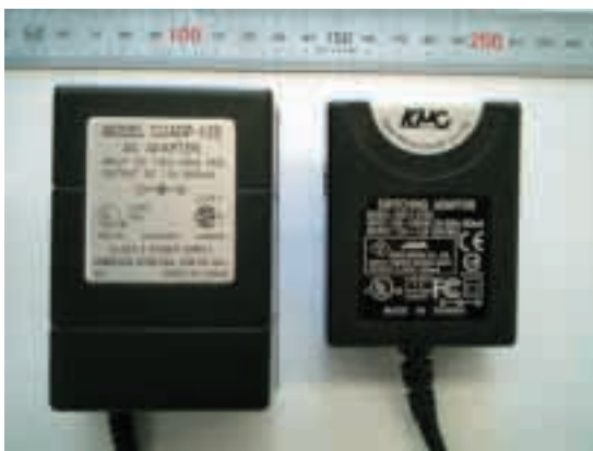
(a) トランス使用タイプ (b) スイッチング電源タイプ
