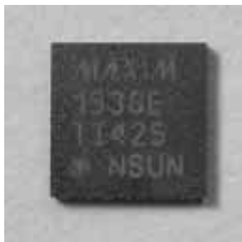
写真1 充電制御 & 電源セクタ IC MAX1538の外観(5×5 mm)
