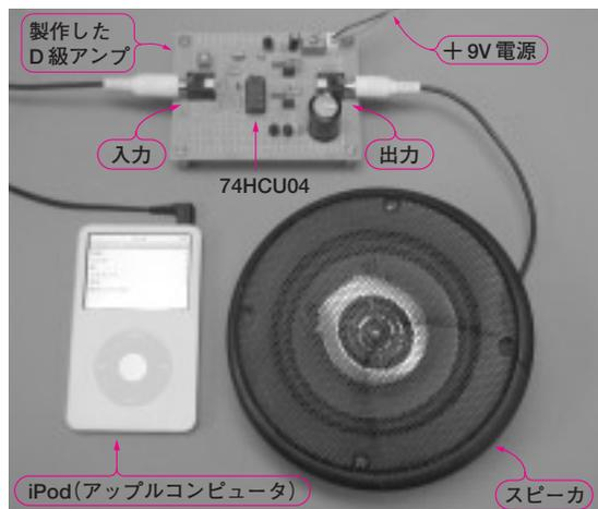
写真5-1 CMOSロジックIC 1個で作れる高効率パワー・アンプ(1W@8Ω)
