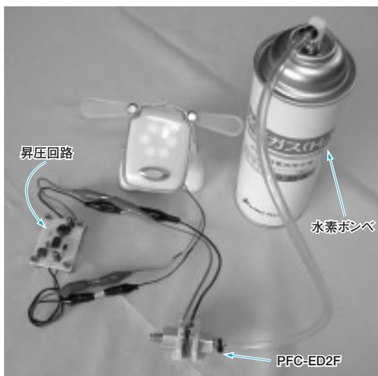
写真14-2 水素ガスを燃料にして動く電子ペット idog (セガトイズ)
