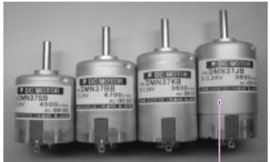
ハウジングの外側の薄い鉄板は、バック・ヨークあるいは補助ヨークと呼ばれるものである。マグネットの能力を十分引き出すために、ハウジング全体を厚くする代わりに磁路の部分の厚みを増やして、磁路の働きを良くする役目がある
