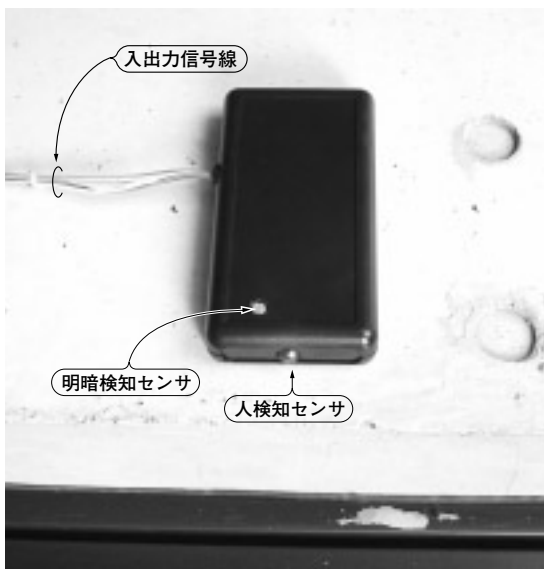
写真9-1 複数のセンサと複数の接点出力をもち、動作モードを設定できる万能センサBOX
