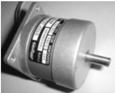
写真3-2 今度は市販のステッピング・モータを発電機として使う(TS3103N124, 多摩川精機)
