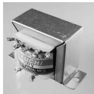
写真1 電源トランスの外観
