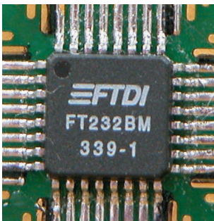
写真1 FT232BMの外観 第5章で製作するUSB-シリアル変換器に搭載されているデバイス
