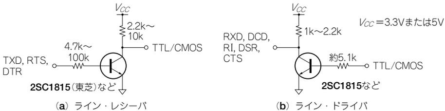
〈図3-3〉 バイアス抵抗内蔵トランジスタ1個による簡易ドライバ回路
