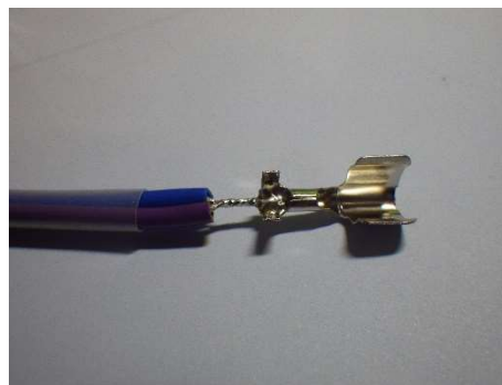
青・紫ケーブルをよじってヒューズケース端子にはんだ付けする
