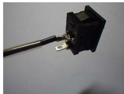
AC プラグケーブルを電源スイッチにはんだ付けし、熱収縮チューブをかぶせる
