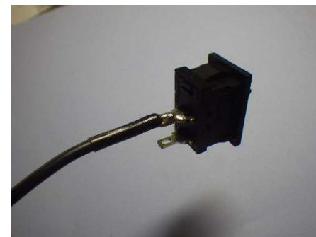
AC プラグケーブルを電源スイッチにはんだ付けし、熱収縮チューブをかぶせる
