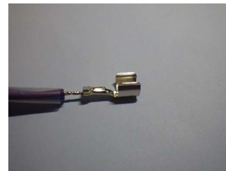
青・紫ケーブルをよじってヒューズケース端子にはんだ付けする
