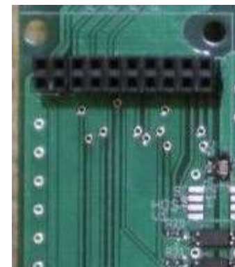
20P ピンソケットは浮きや傾きがないように注意
