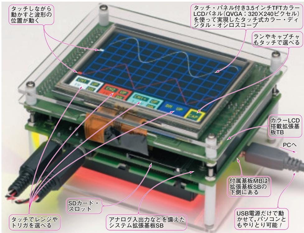
写真2 H8 マイコン基板と拡張基板2種類を使ったタッチ式デジタル・オシロスコープを製作
