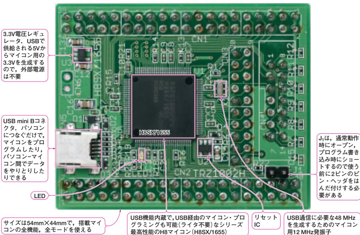
写真1 USB に挿すだけでとにかくすぐに使えるように設計した付属 H8 マイコン基板“MB”
