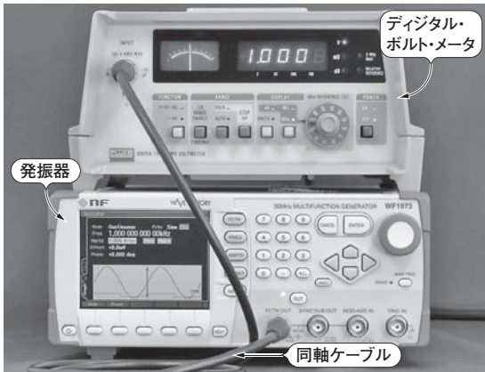
(a) 発振器の出力電圧をデジタル・ボルト・メータで計測しているところ
