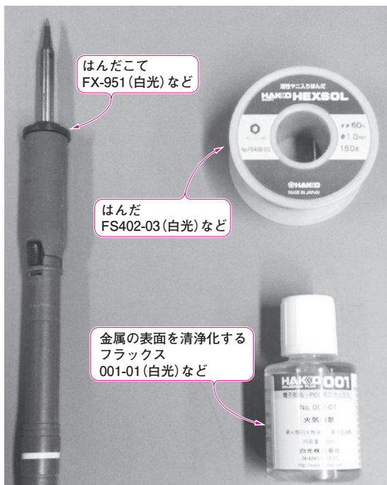
写真1 はんだ付けに利用するフラックスやはんだこて フラックスで酸化皮膜を取り除くと、ぬれが生じて接合性がよくなる。電子機器に使用するフラックスは、主に樹脂(ロジン)系が使われている。フラックスやヤニ入りはんだの効果は動画で見ることができる
