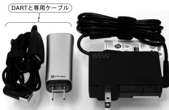
写真1 ノート・パソコン用ACアダプタでは世界最小の「DART」は同規格製品と比較してかなり小さく見える。比較対象のACアダプタも比較的小さく軽い品種なのに一回り以上小さい。
