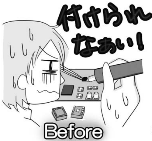
(a) QFPはつけずらく、LCCパッケージはつけられない
