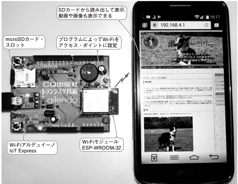
写真1 IoT Expressで作ったI/O Webサーバ スマホでWebページを表示しているところ。Webページ・データはIoT ExpressのSDカードに格納されている
