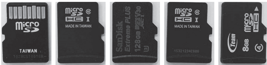
(a) Card A (8Gバイト, TPMSM-GS 1S, 産業用, SLC型, ページ・マッピング, ソリッドギア製) (b) Card B (8Gバイト, TPMSM-USAS, 民生用, SLC型, フロック・マッピング) (c) Card C (128Gバイト, Extreme Plus) (d) Card E (16Gバイト, Exceria) (e) Card F (8Gバイト, KTTGAT)
