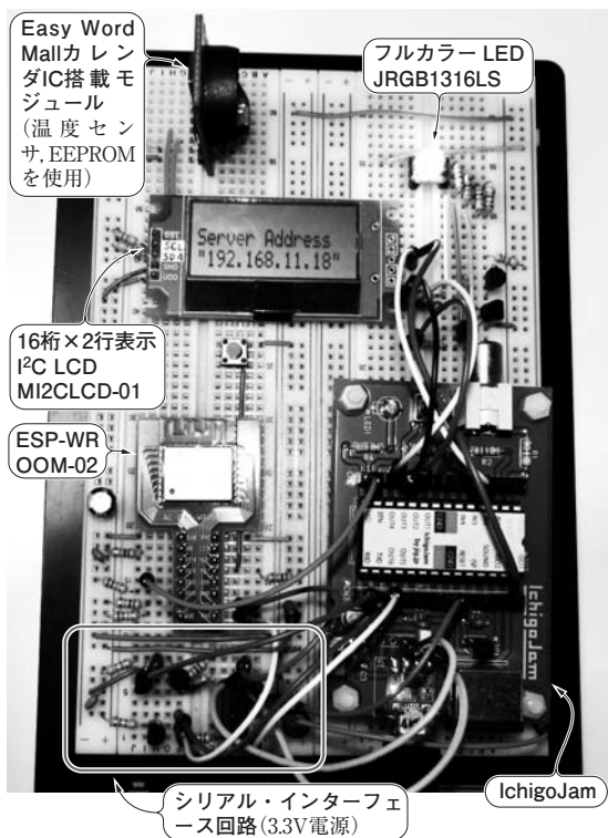
写真1 製作したIchigo Webサーバ 温度計とカラーLEDコントローラの機能をもつ。ノートパソコンのWebブラウザからリモート制御する
