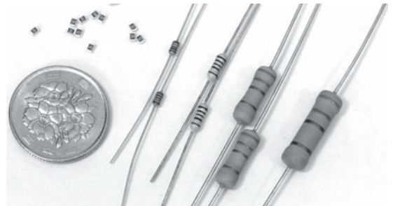
写真1 抵抗…用途に合った種類やサイズを選ぶ サイズはさまざまだが小さいほど使える電力や電圧が小さく/低くなる
