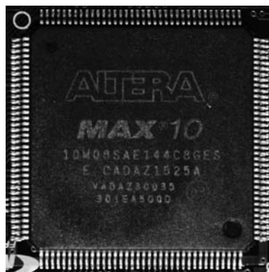
写真1 MAX 10(10M08SAE144C8GES)の外観 8000LE, 単一電源のアナログ機能タイプ。パッケージは20mm×20mmのEQFP-144
