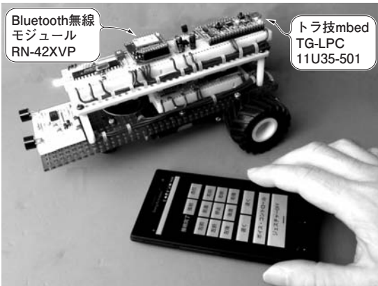
写真1 製作した mbed ラジコン・カー 障害物検知器とおしゃべり機能を搭載し、スマホの画面でリモコン制御 できる
