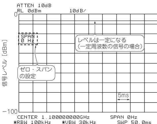
図1 スペアナのゼロ・スパン設定の例。1100 MHzの無変調(CW)信号を観測(CENTER = 1100 MHz, SPAN = 0 Hz)
