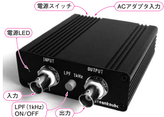
写真1 製作した10 Hz~1 MHz, 1 nV/√Hzのロー・ノイズ・アンプLNA-1(ケース付き組み立てキットを発売予定.詳しくは稿末のコラムを参照)
