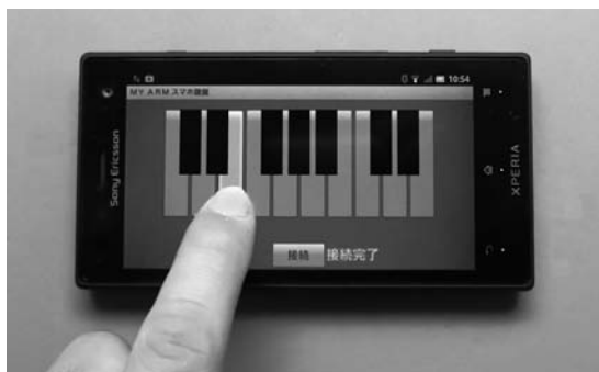
写真2 スマホのタッチ・パネルに表示したキーボード鍵盤をタップするとリモートで曲を演奏できる
