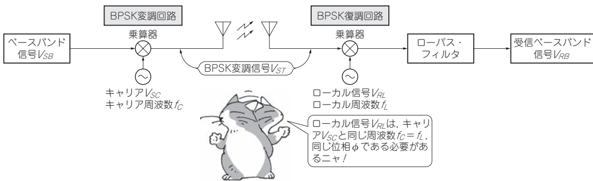
図1 BPSK復調の最初の処理はローカル信号 V_{RL} との「掛け算」
