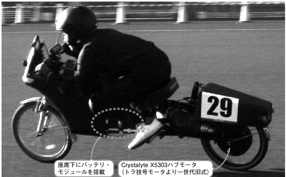
写真1 リン酸鉄リチウム・イオン蓄電池を搭載した電動バイク「ザ・ウインド・フロム・ザ・サン」浜松のソーラーバイクレース用に筆者らが製作した
