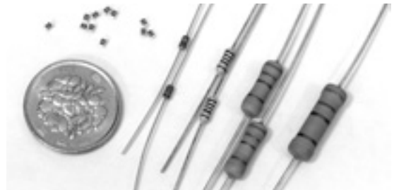
写真1 抵抗のタイプやサイズはさまざまだが…サイズが小さいほど使える電力や電圧が小さく低くなる
