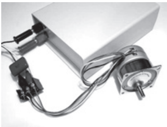
写真3 同期モータの回転テストに使える
