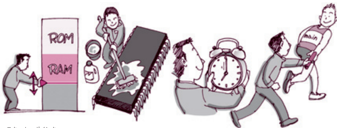
図1 マイコンはmain関数に到達するまでにさまざまな準備処理を行っている 電源を入れても動き出さないときはマイコンが初期の処理を分析する必要がある
