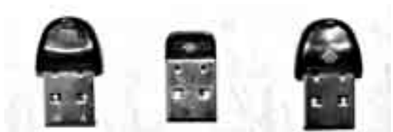
写真2 入手しやすくなった Bluetooth-USB Dongle を使用する プロフィールを内蔵していない安価な製品
