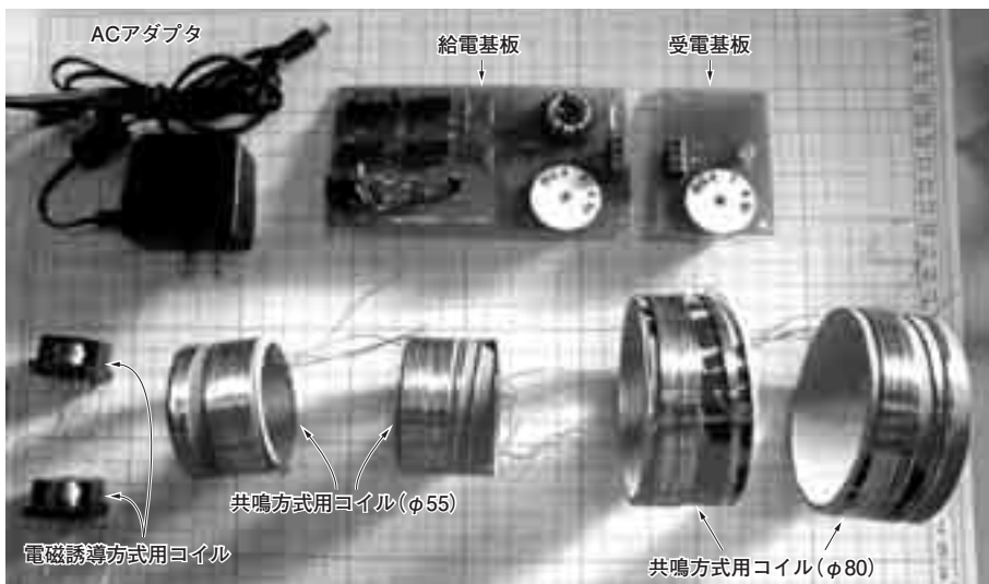
写真1 ワイヤレス給電の実験に使用した基板とコイル
