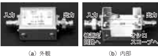
写真1 ロー・パス・フィルタ・ボックス
