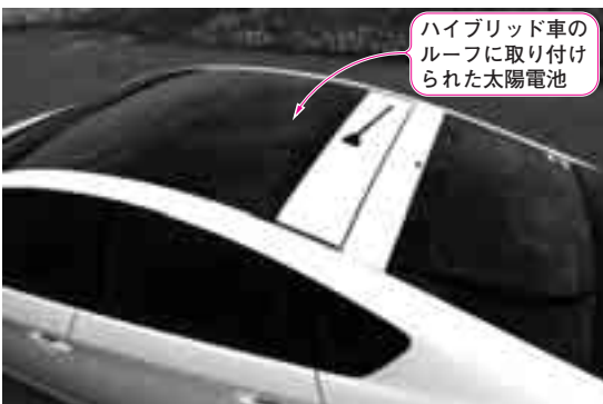
写真1 ハイブリッド車「プリウス」に搭載されているソーラ・パネル
