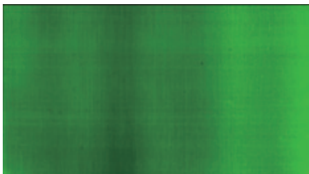
(g) ディスプレイの輝度むら (第4章) ドライブ・トランジスタの特性ばらつきによるもの。画素回路設計でこのばらつきを補正するのが回路設計者の腕の見せどころ
