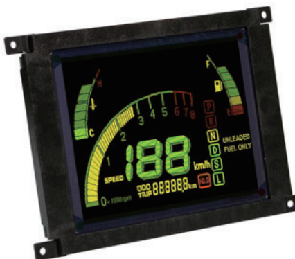
写真5 無機ELディスプレイによる速度計(プレーナー) 動作10万時間以上, 衝撃に強い
