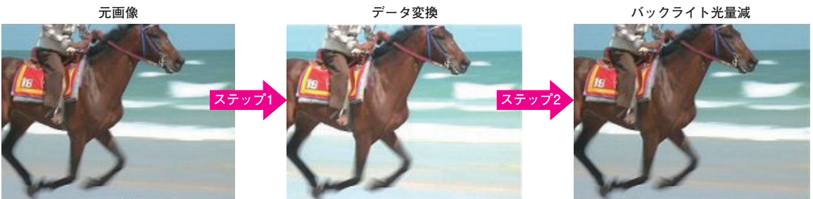
(e) LCDコントローラICの機能 (第3章) 画像データの輝度を高にしたあとバックライトの光量を落とすことで低消費電力化
