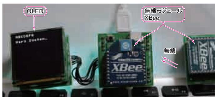
写真6 無線モジュール×Beeをつなぐとワイヤレス・システムが完成する
