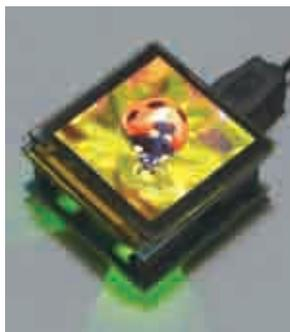
(d) 2枚のマイコン基板で円周率を高速に並列計算…左側の基板は1~100桁、201~300桁…を計算。右側の基板は101~200桁、301~400桁…を計算する
